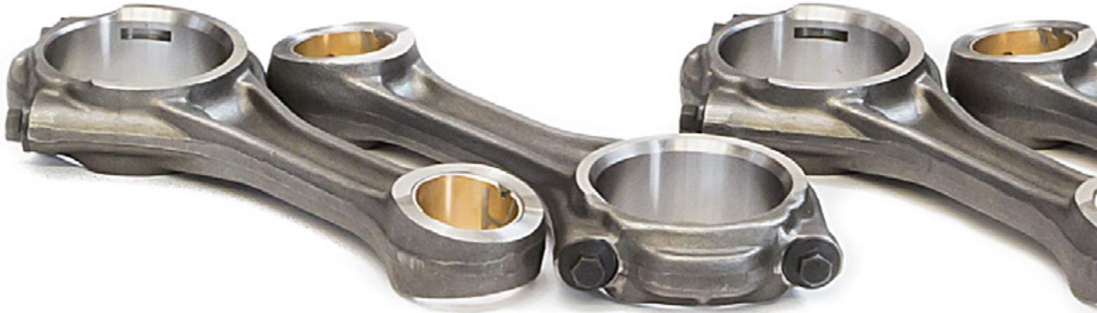
La biella è l'organo che collega il pistone all'albero motore e che consente la trasformazione del moto rettilineo (del pistone) in movimento di rotazione (dell'albero); generalmente può essere realizzata in ghisa sferoidale o in acciaio altolegato (per diverse applicazioni esistono anche in titanio ed alluminio).
